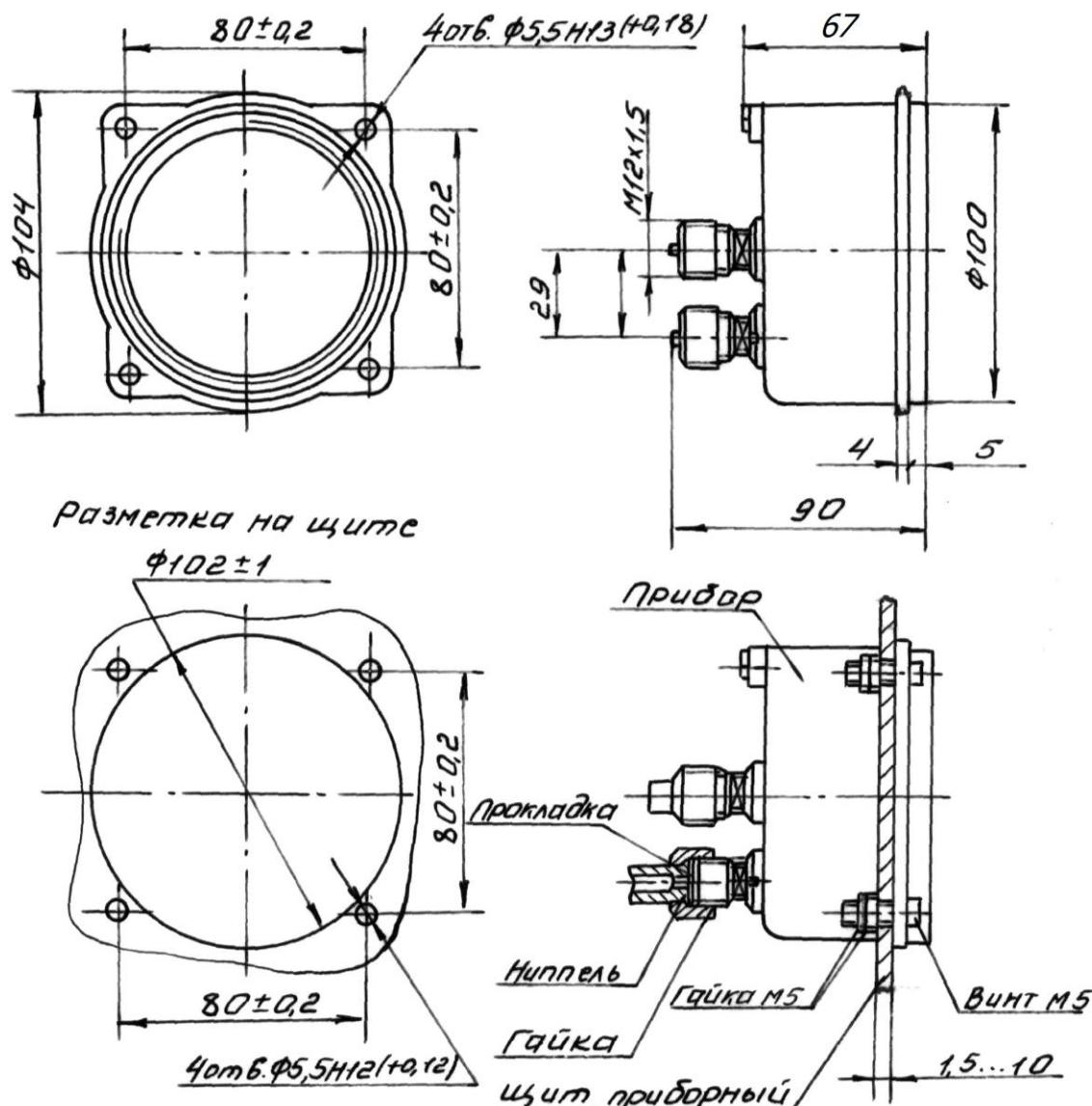
Рисунок 5 – Габаритные и присоединительные размеры прибора
